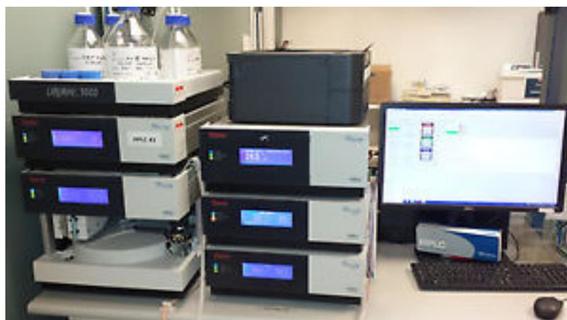
Figura 7: Dionex UltiMate 3000 HPLC (Thermo Fisher Scientific Inc, Italy) accoppiato ad un triplo quadrupolo (API 2000; AB Sciex, Germany).
